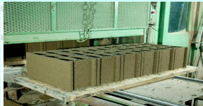
Blocs frais avec 7,3% de granulats recyclés [Dehaut, 2011]
